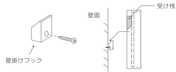
壁面に付属の「壁掛けフック」をビスで取り付け、
